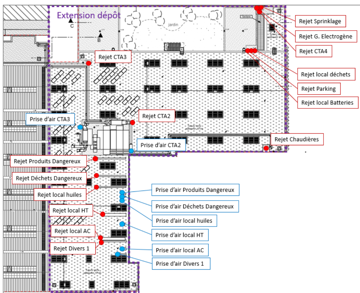
Figure 64 : Prises et rejets d'air localisées en toiture de l'extension du dépôt (source : Architecte)
